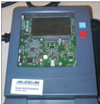
美信推出的新型智能电表，采用了G3-PLC电力线通信标准。
